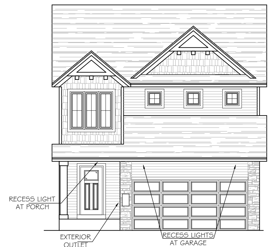
FRONT ELEVATION SCALE: 1/8" = 1'-0"
