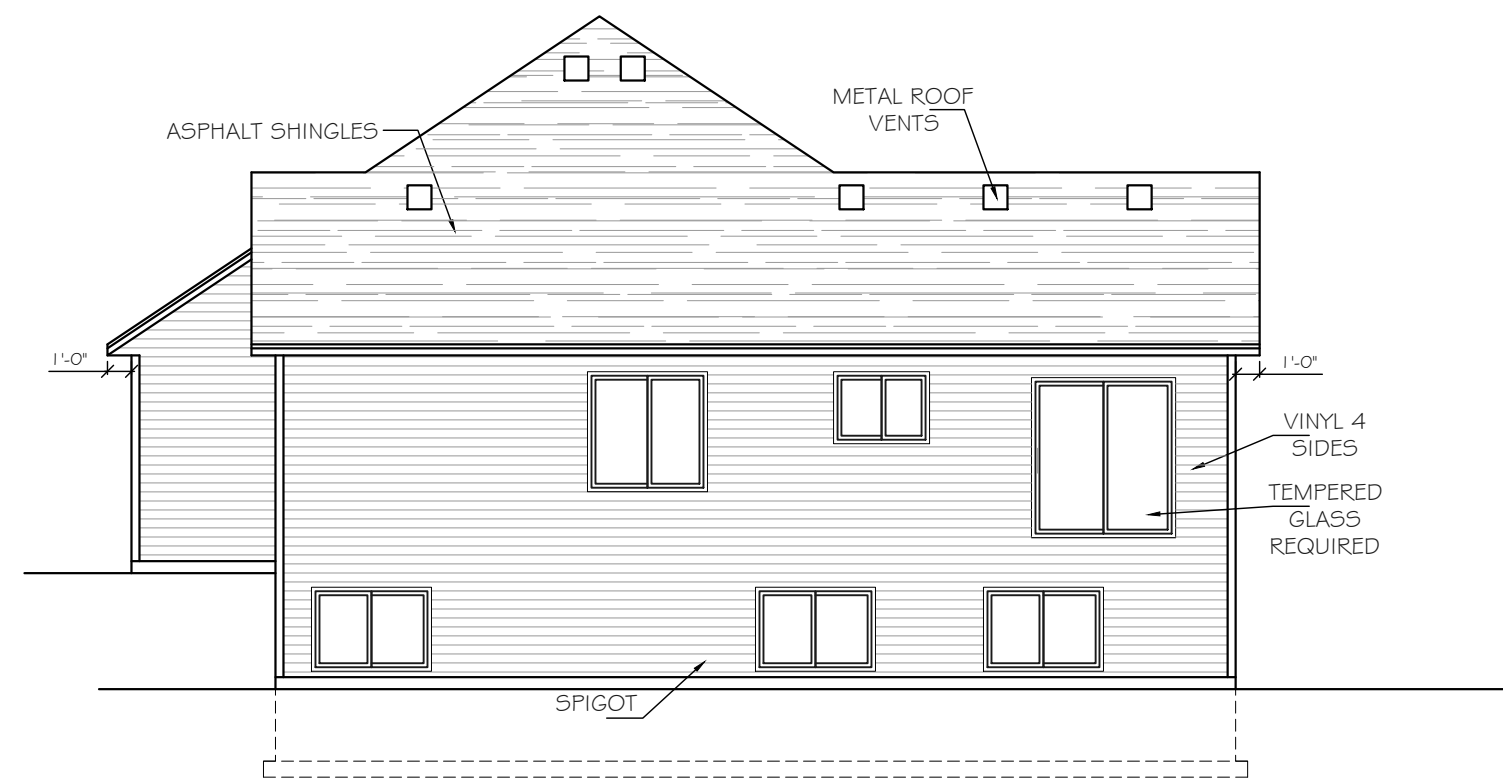
REAR ELEVATION SCALE: 1/8" = 1'-0"
